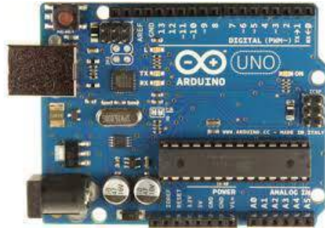
Gambar 2.14 Hardware Arduino Uno
