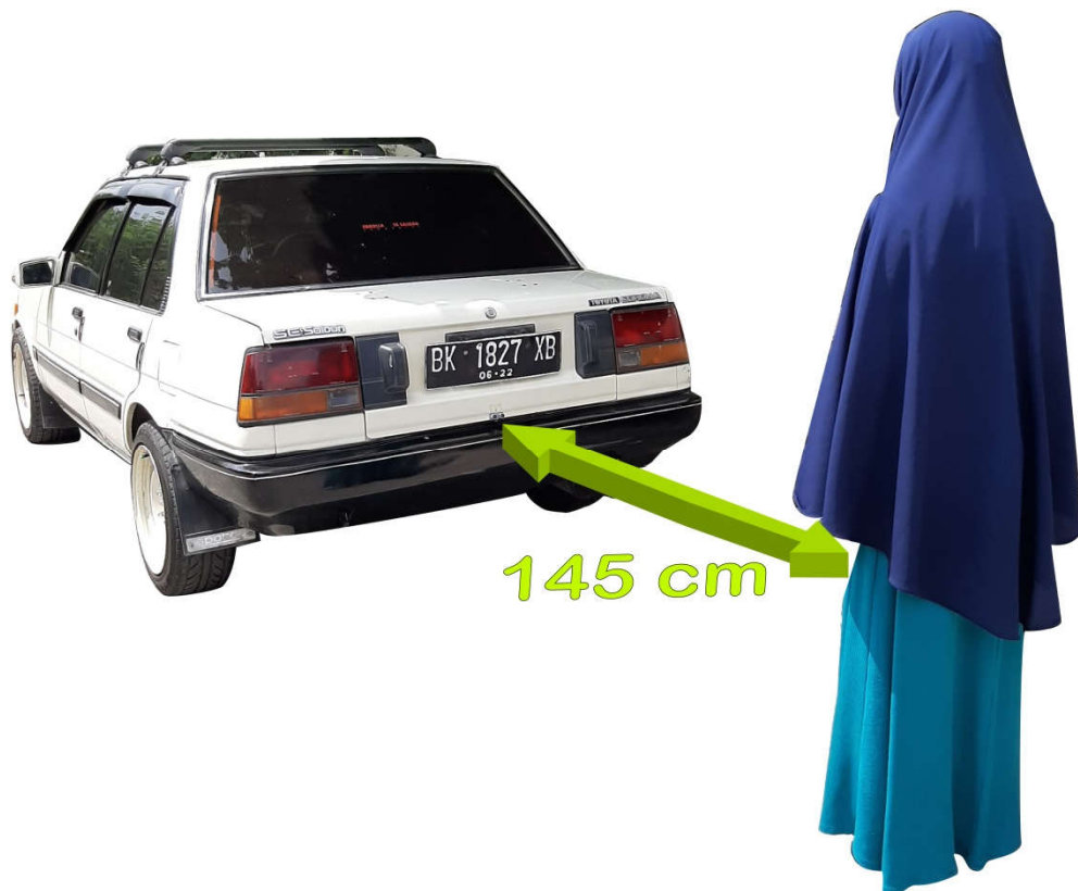
Gambar 4.4. Sensor Belakang dan Objek dengan Jarak 145 cm
