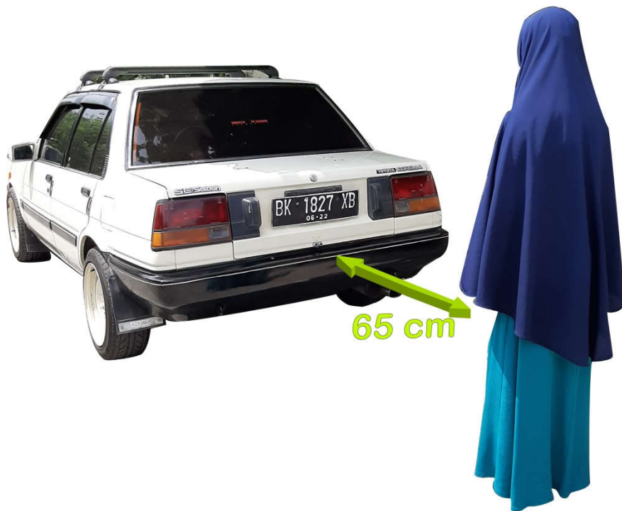
Gambar 4.2. Sensor Belakang dan Objek dengan Jarak 65 cm
