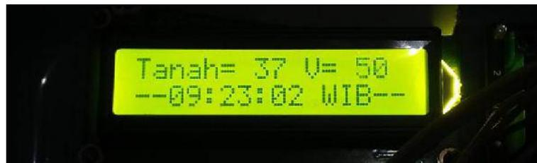
**Gambar 4.2 Bagian Display Hasil Pembacaan Sensor**
