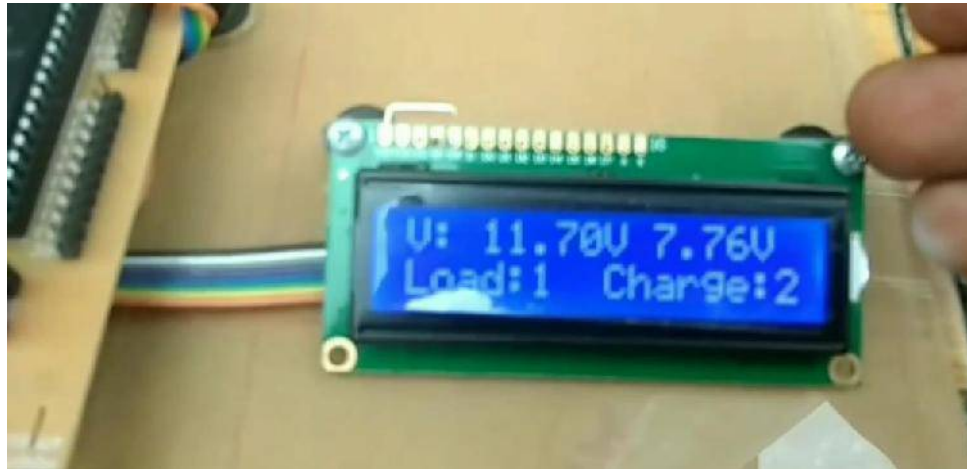
Gambar 4.10 Hasil pengujian Baterai 2 Charge Baterai 1 Load
