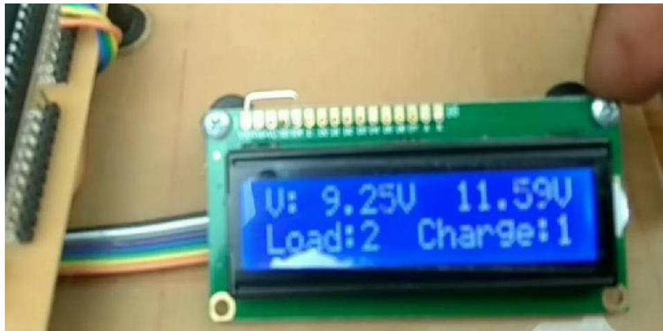
Gambar 4.9 Hasil Pengujian Baterai 1 Charge Baterai 2 Load Sumber: Penulis,2019
