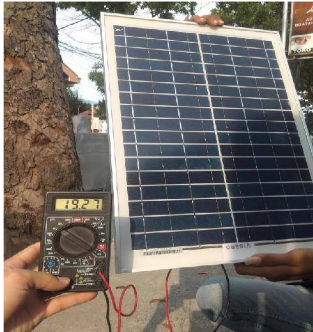
Gambar 4.6 Hasil Pengujian 2 Tegangan Solar Cell pada waktu 12:00 WIB dengan Alat Ukur Sumber: Penulis,2019
