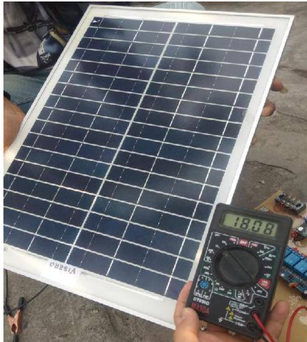
Gambar 4.7 Hasil Pengujian 3 Tegangan Solar Cell pada waktu 14:00 WIB dengan Alat Ukur Sumber: Penulis,2019
