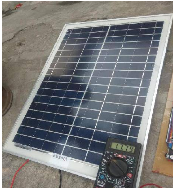
Gambar 4.5 Hasil Pengujian 1 Tegangan Solar Cell pada waktu 10:00 WIB dengan Alat Ukur Sumber: Penulis,2019
