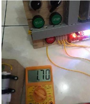
**Gambar 4. 5 Pengujian Sensor Pada Posisi *Low Level***
