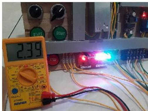
**Gambar 4. 6 Pengujian Sensor Pada Posisi *Medium Level***
