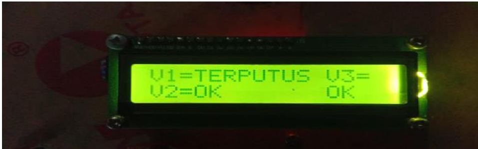
Gambar 4.5 Tampilan Pada LCD Pada Saat Terjadi Kerusakan (Penulis,2019)
