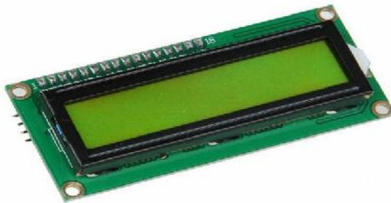
Gambar 2.6 LCD 16 x 2 I 2 C
