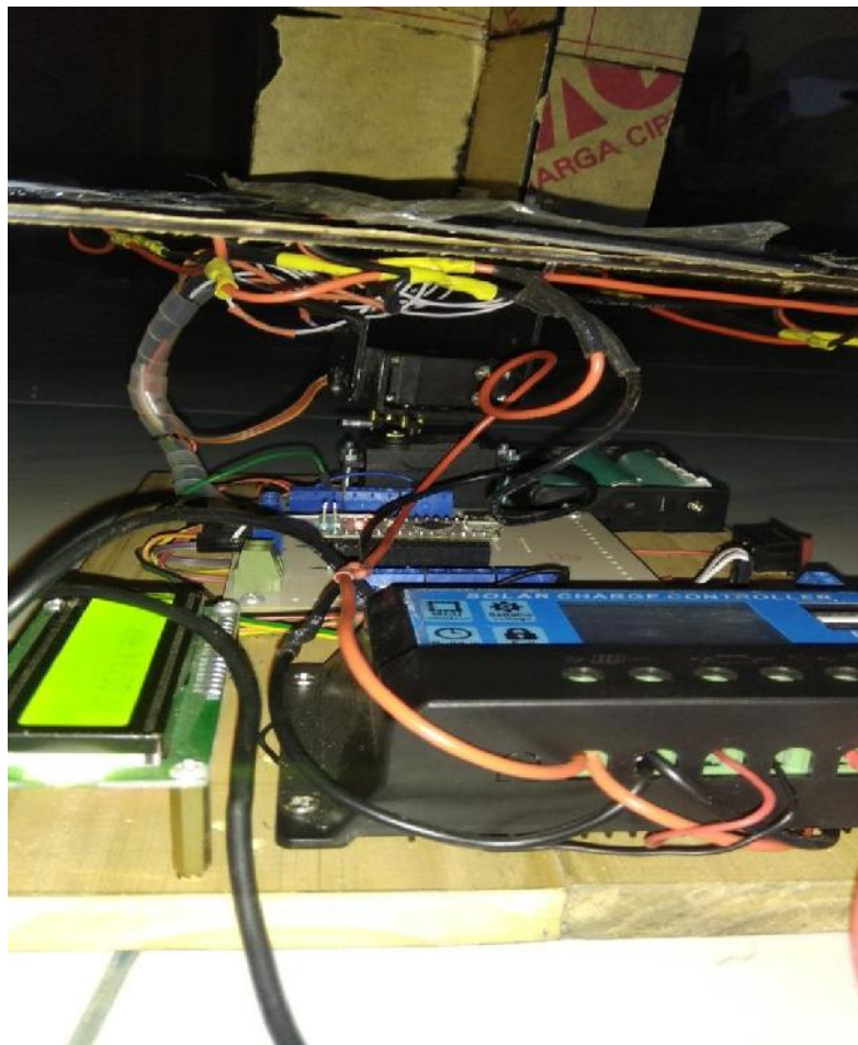
Gambar 4.2 bentuk fisik dari rangkaian arduino pada kotak kontrol (Sumber : Penulis, 2020)
