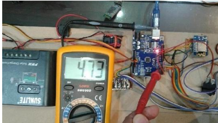
Gambar 4.12. Proses pengukuran pin mikrokontroler
