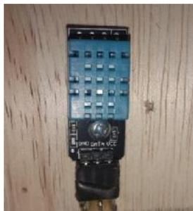
**Gambar 2.5 Sensor DHT11**
