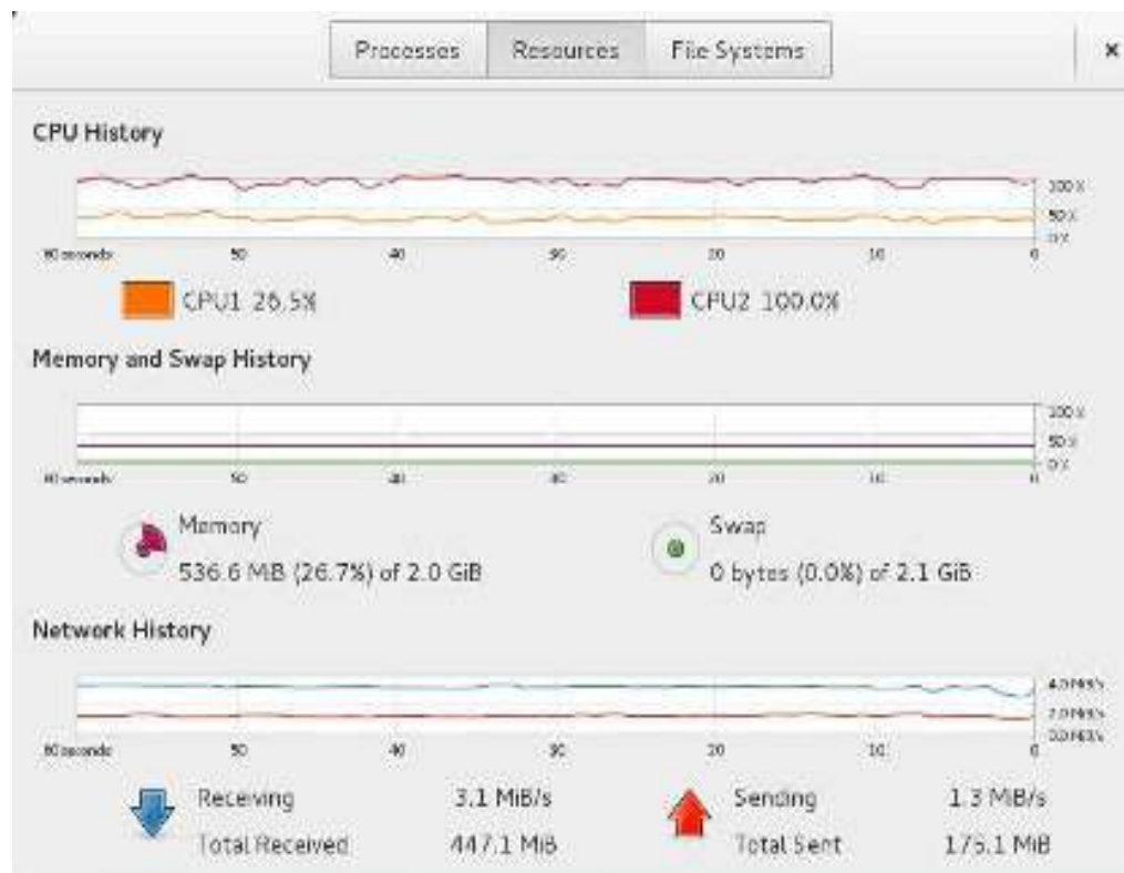
Gambar 4.4 Monitoring Kinerja Server Terjadi Serangan
