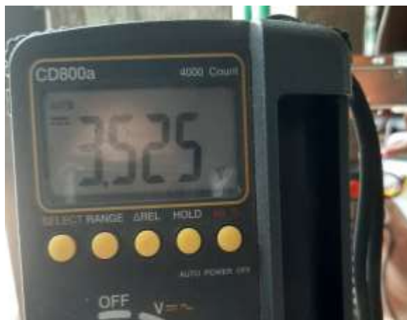
Gambar 4.6 Pengukuran Tegangan pada Magnetic Switch / Door Sensor ketika Magnet dijauhkan
