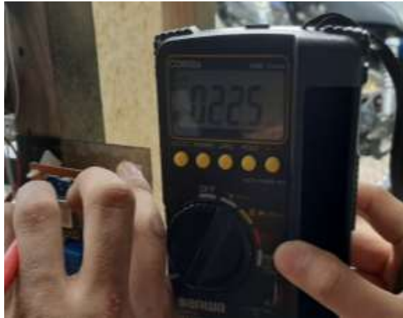
Gambar 4.3 Pengukuran Tegangan pada ketika Push Button Ditekan
