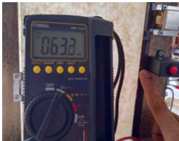
Gambar 4.7 Pengukuran Tegangan pada Relay ketika dibuka dari Blynk
