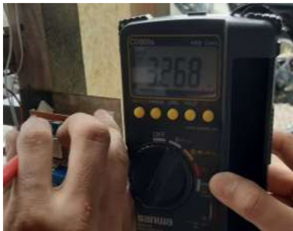
Gambar 4.4 Pengukuran Tegangan ketika Push Button Dilepas
