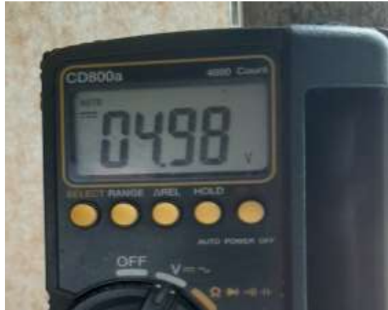
Gambar 4.2 Pengukuran Tegangan pada Modul Step Down LM2596
