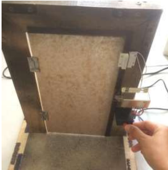
Gambar 4.11 Solenoid Terkunci Sebelum Push Button Ditekan
