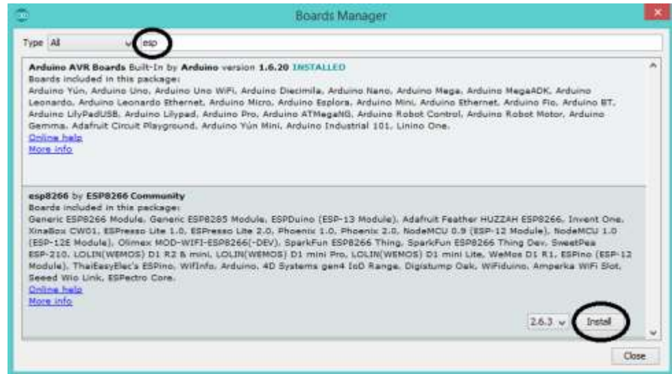
Gambar 3.12 Instalasi esp8266 di Arduino IDE
