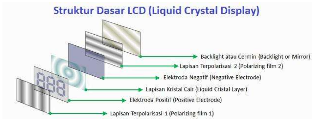
Gambar 2.6 Struktur LCD
