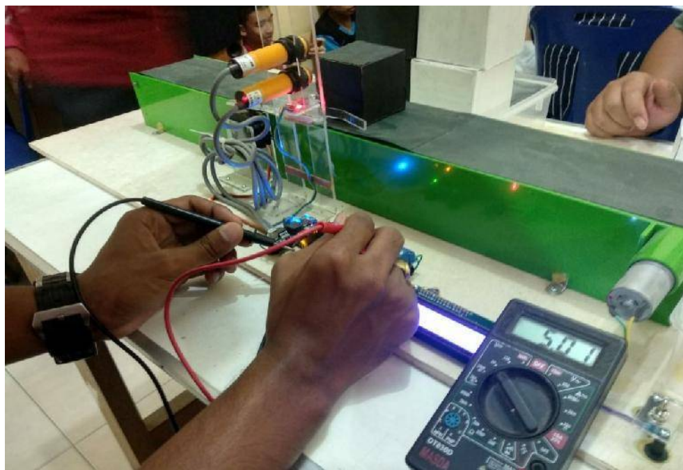
Gambar 4.3 Arus Tegangan Sensor Warna pada Benda Hitam
