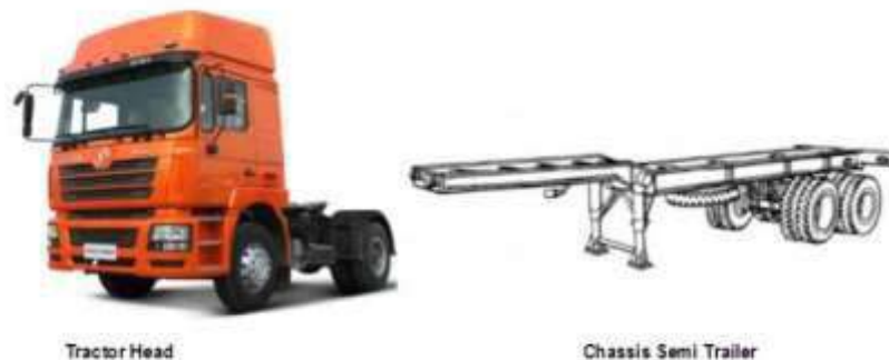
Gambar 2. Kepala Truk Dan Gandengan ( Chassis Semi Trailer )
