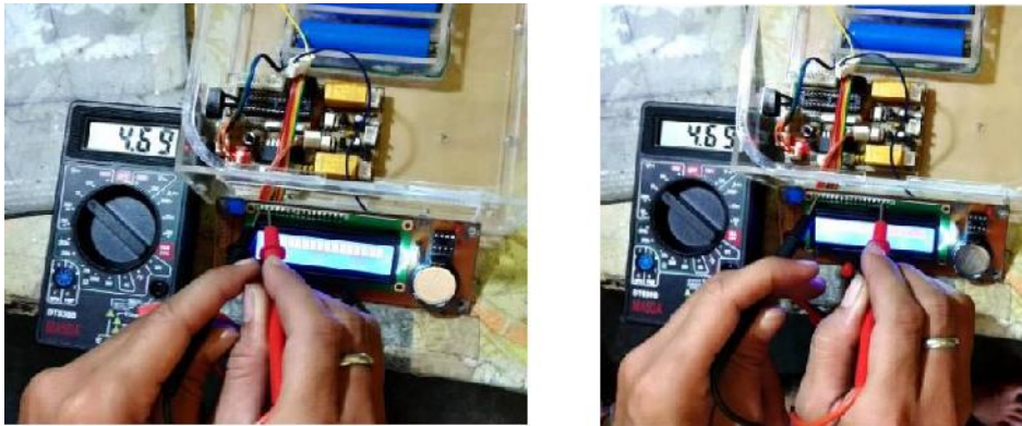
Gambar 4.3 Pengujian Tegangan pada pin VCC dan Backlight LCD (sumber : Rancangan Penulis)
