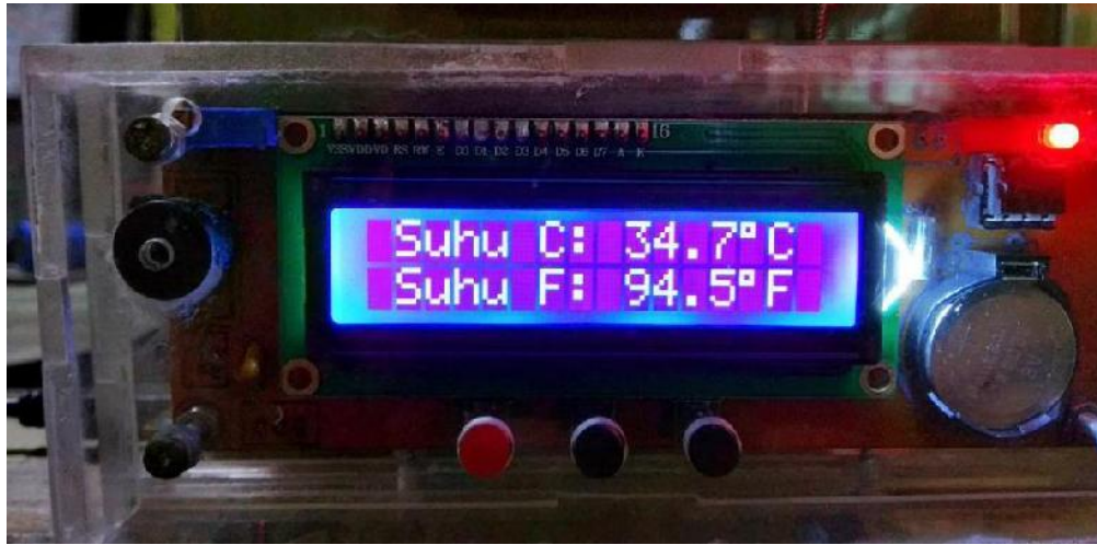
Gambar 4.9 Hasil Pengujian Sensor Suhu LM35 (sumber : Rancangan Penulis)
