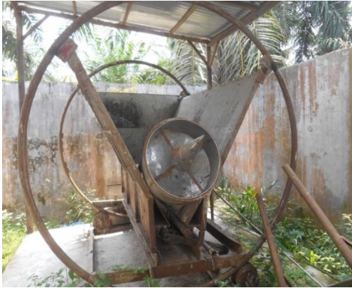
Gambar 1 Hoist dan Alat Pembersih Rumen Yang Tidak di Gunkan
