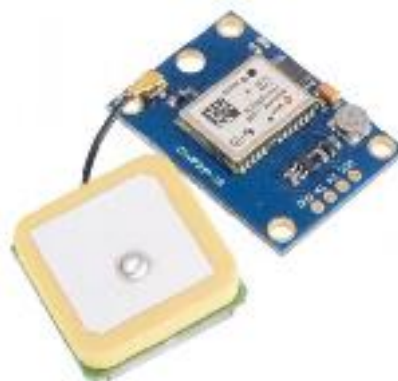
Gambar 3.4. Modul GPS Neo-6m
