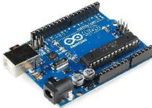
Gambar 3.2. Modul Arduino Uno
