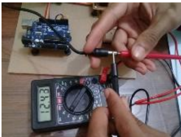
Gambar 4.2. Pengujian Tegangan Output Power Supply
