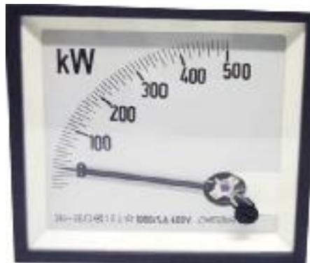
**Gambar 2.22: Kilowatt Meter**
