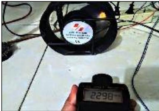
**Gambar 4.13 Pengujian Motor Kecepatan *LOW***
