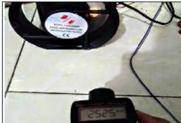
**Gambar 4.11 Pengujian Motor Kecepatan *HIGH***
