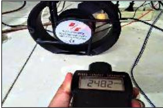
**Gambar 4.12 Pengujian Motor Kecepatan *MEDIUM***
