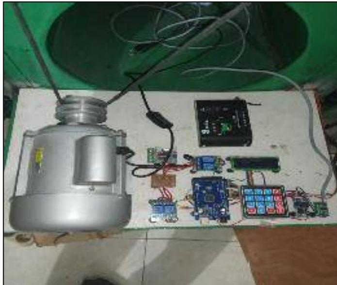
**Gambar 4.1 Perakitan Komponen dan Modul Alat**
