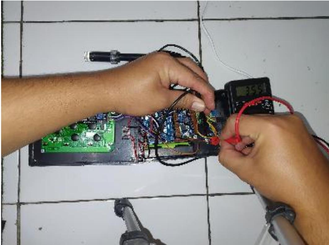
**Gambar 4.7 Pengukuran Tegangan Modul TP4056**
