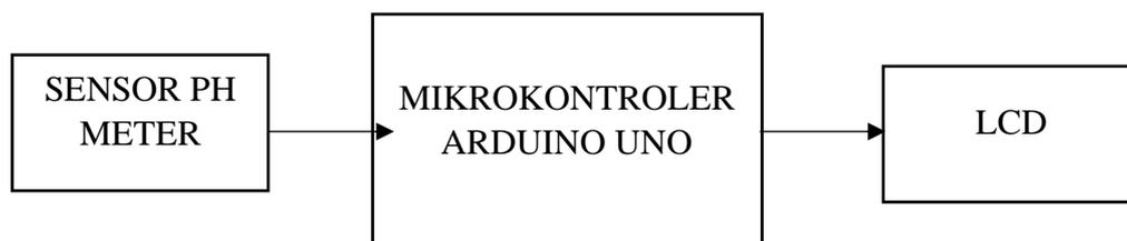
**Gambar 3.1 Diagram Blok**
