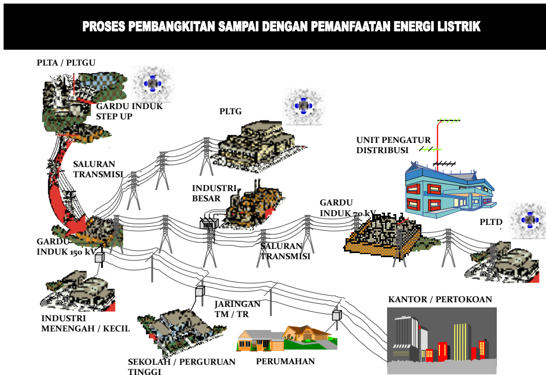
Gambar 2.1 Sistem Tenaga Listrik
