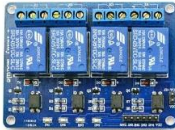
Gambar 2.5. Relay 5 volt 4 channel
