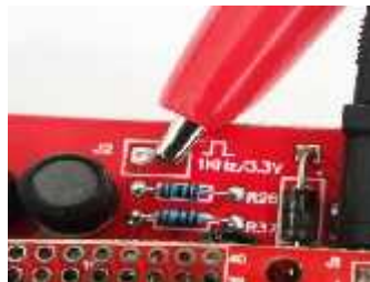
Gambar 2. 21 Hubungan probe positif DSO138
