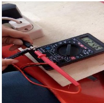
Gambar 4.7 Pengukuran Tegangan Catu Daya 12 V Sumber : Penulis, 2020
