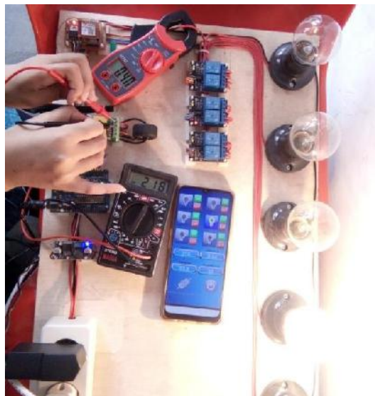
Gambar 4.10 Pengujian Lampu 100 Watt Sumber : Penulis, 2020
