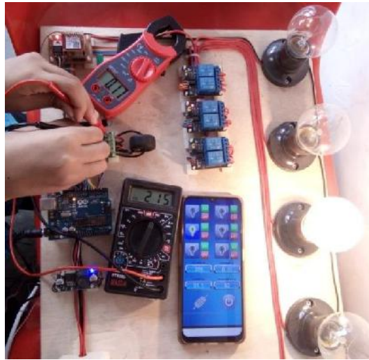
Gambar 4.9 Pengujian Lampu 60 Watt Sumber : Penulis, 2020
