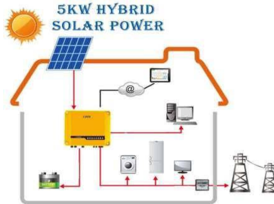
Gambar 2.3 Prinsip Kerja PLTS On-Grid
